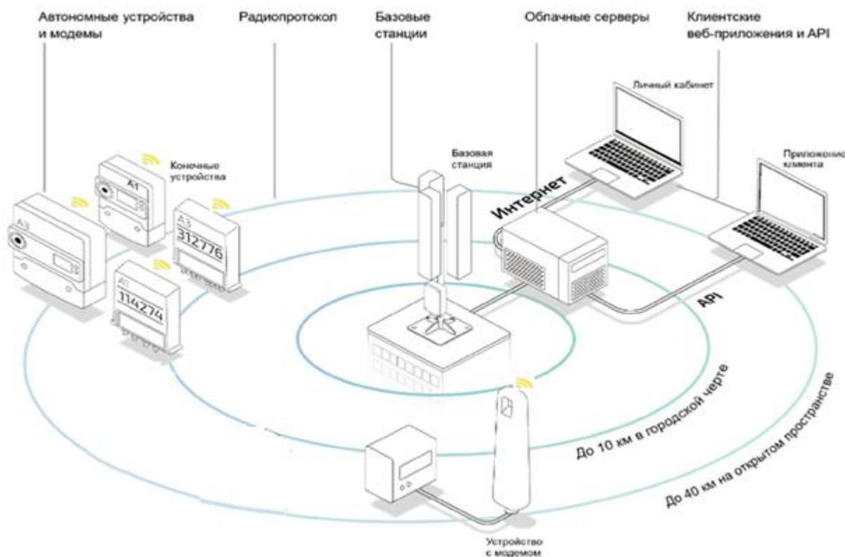
Рисунок №1 Организация каналов (линий) связи на базе технологии передачи данных LPWAN.
